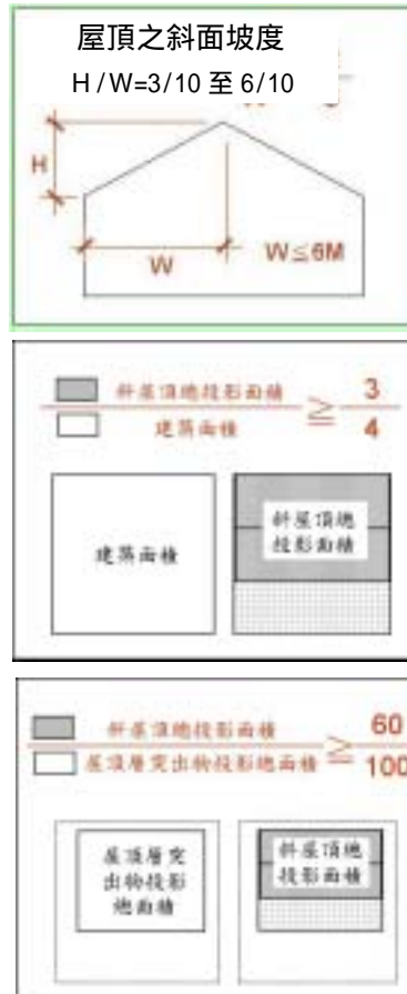
附圖7 斜屋頂設計準則示意圖
